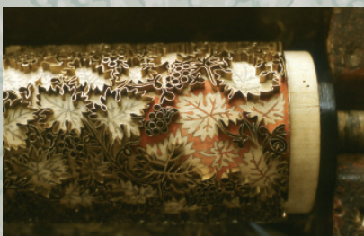
Druckwalze für die Tapete mit grünem Weinlaubmuster während der Fertigung für Schillers Wohnhaus in Weimar
